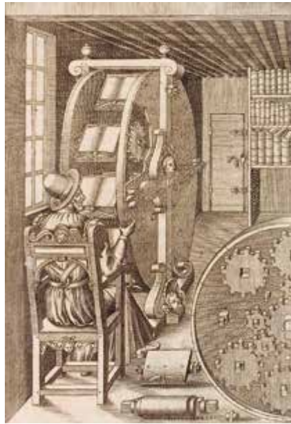
Abb. 1: Büchermühle, in: Agostino Ramelli, Le diverse et artificiose machine , Paris 1588, S. 317, Abb. 188.
